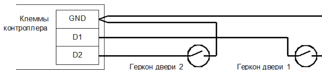
Рис. 34. Подключение датчиков открытия дверей.
