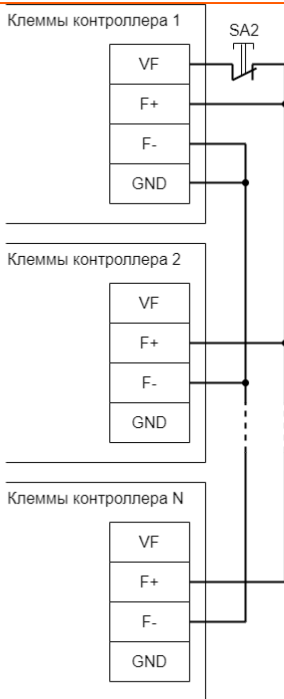
Рис. 8. Подключение кнопки разблокирования к нескольким контроллерам.
