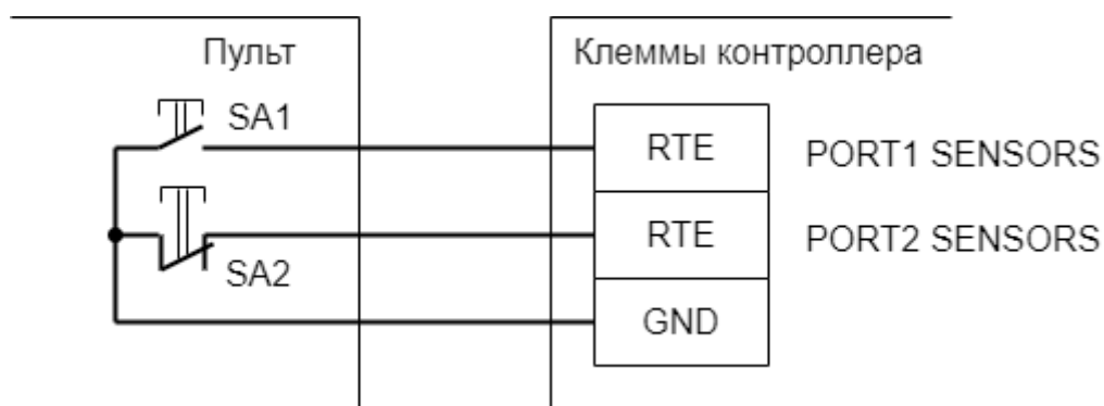
Рис. 67. Пример подключения пульта ручного управления шлагбаумом/воротами к контроллеру, кнопка «Стоп» нормально замкнута.
