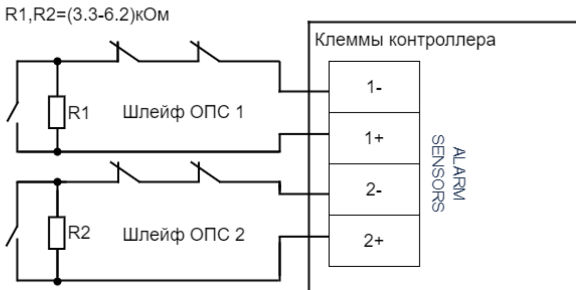
Рис. 8. Подключение датчиков ОПС без внешнего питания.
