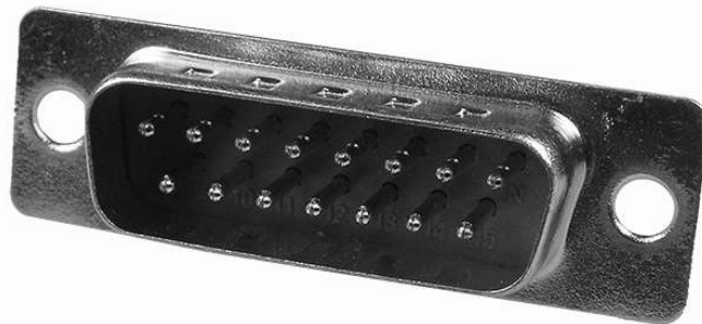
Рис. 56. Штекер DB-15M, подключаемый к блоку механики PERCo.
