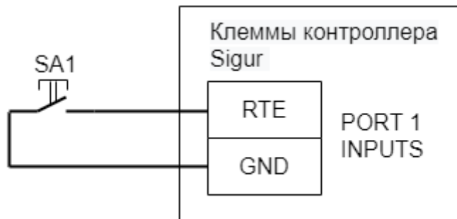
Рис. 35. Пример подключение кнопки запроса прохода.
